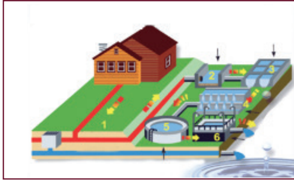
شكل (7): شبكة الصرف الصحي
